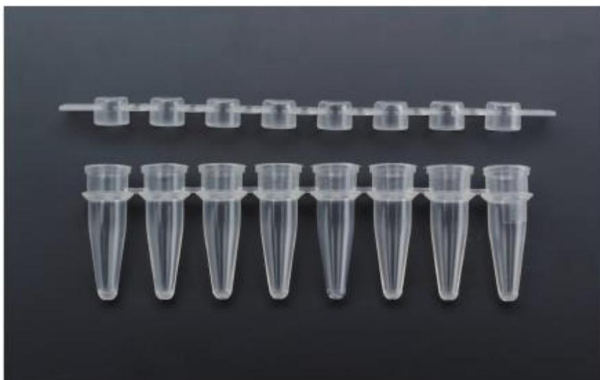
Die extrem dünnwandigen Reaktionsgefäße des 8-PCR-Streifens im „klassischen“ Design gewährleisten einen optimalen Wärmetransfer in das Innere der Gefäße und damit reproduzierbare PCR Reaktionen.
