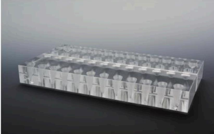
Besteht aus einem Plexiglasblock mit 12 × extra starken Dauermagneten zur schnellen Magnetseparation in 1,5 ml und 2,0 ml Tubes.
