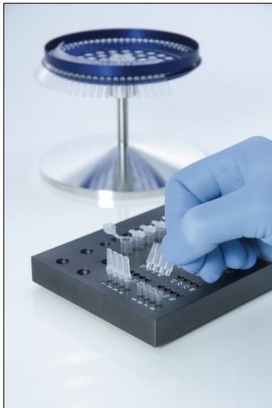
3. Setzen Sie die Streifenröhrchen in den 72-Well Rotor. Stellen Sie dabei sicher, dass jedes Röhrchen an der korrekten Position und korrekt ausgerichtet sitzt.
