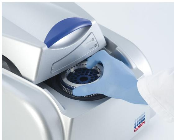
6. Schließen Sie den Deckel und richten Sie das Laufprofil mithilfe der Rotor-Gene Q Software ein.
