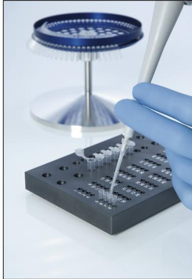
2. Verschließen Sie die Streifenröhrchen sicher mit den Deckeln und führen Sie eine Sichtprüfung durch, um den festen Verschluss zu bestätigen.
