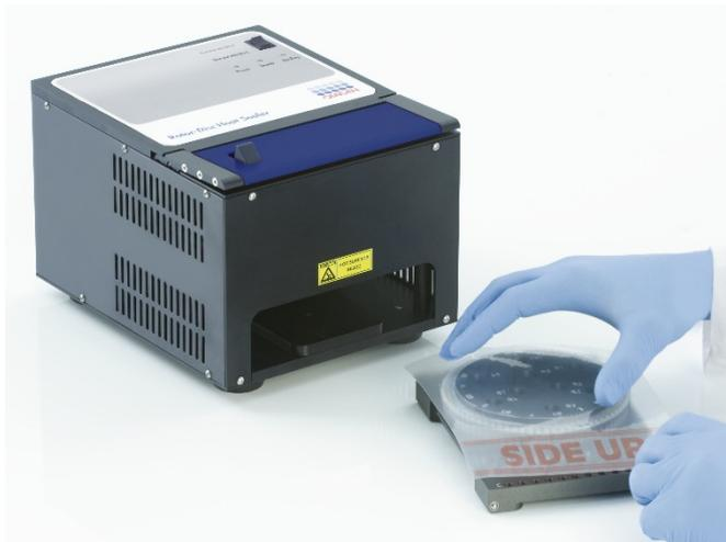
7. Schieben Sie den Ladeblock mit abgedeckter Rotor-Disc entlang den seitlichen Führungen des Ladeblocks in den Rotor-Disc Heat Sealer. Stellen Sie sicher, dass der Rotor-Disc Loading Block vollständig eingeführt worden ist.
