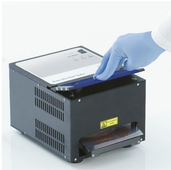
9. Nach Absenken des Versiegelungsmechanismus leuchtet das Anzeigelämpchen „Sealing“ orange. Befindet sich der Rotor-Disc Loading Block nicht in der korrekten Position, ertönt ein Warnsignal.
