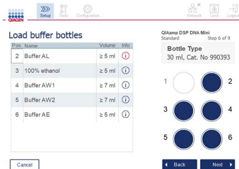
Bildschirm „Load buffer bottles“ (Pufferflaschen laden)
