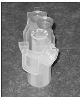
Deckel des 1,5-ml-Mikrozentrifugenröhrchens im falschen Schlitz des Rotoradapters
