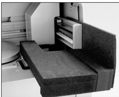
**Schaumstoffschutz für Roboterarm.**
