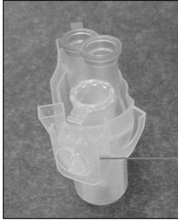
Deckel des 1,5-ml-Mikrozentrifugenröhrchens in der korrekten Position
