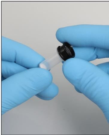
**Befestigen eines Spin-Säulen-Adapterrings.**
