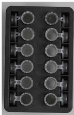
Deckel der Probenröhrchen müssen fest in die Schlitz an den Seiten des Schüttlergestells gesetzt werden
