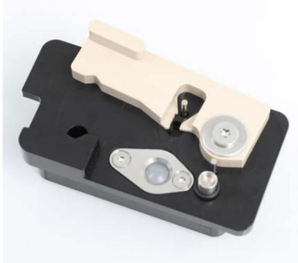
O-Ring-Tool mit vorbereitetem neuem O-Ring
