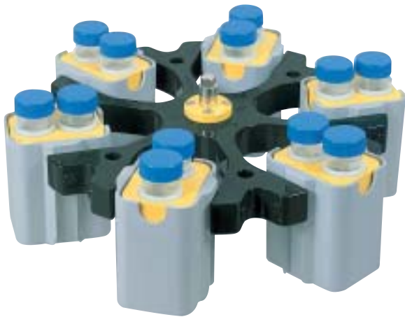
Ausschwingrotor 4-fach, n = 4.500 min -1 , RCF 5.252, max. 4 x 1.000 ml. Stahl mit Hettodur ® -Beschichtung, mit Gehänge 4293 für 3-fach Blut- beutelsysteme. Bestell- Nummer 4294
