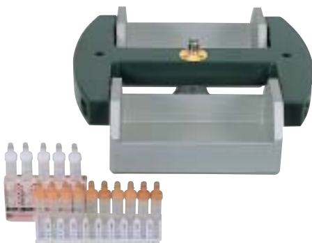
Ausschwingrotor 2-fach für Platten und Racks, n = 3.600 \text{ min}^{-1} , RCF 2.695, max. 20 Racks.
